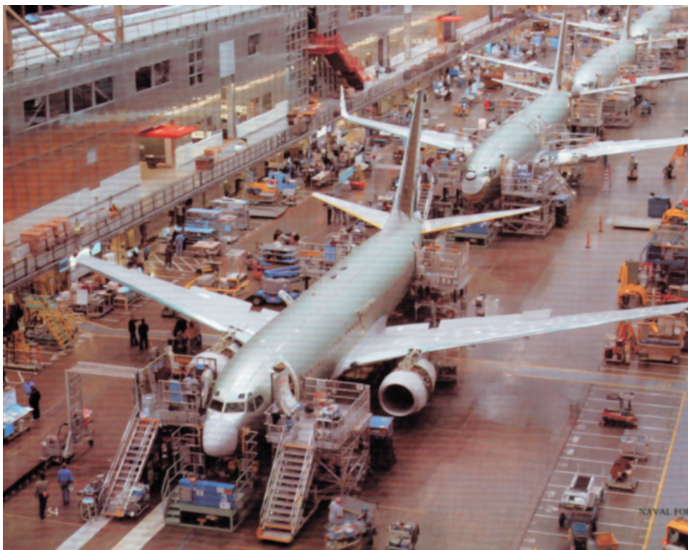
Сборка опытной партии самолетов БПА Р-8А на производственных мощностях гражданского авиастроительного предприятия (г. Рентон, штат Вашингтон). При серийном производстве военной версии самолета его сборочные площадки будут отделены барьером безопасности
