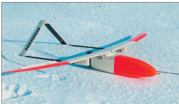
Беспилотный летательный аппарат, созданный для ведения разведки в полярных областях
